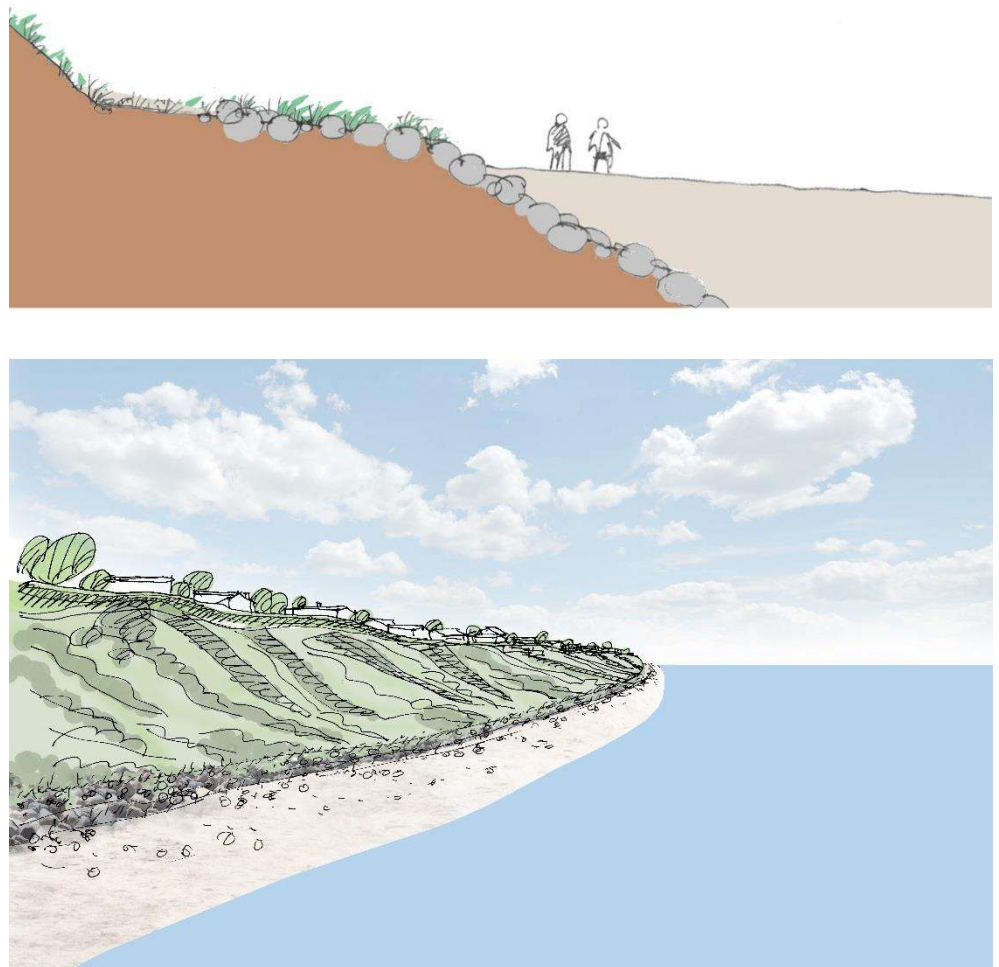
Figur 2.1: Overordnede kysttekniske princip for kystbeskyttelsesprojektet Nordkystens Fremtid, som omfatter strandfodring med sand, grus og ral (Kilde: Kystteknisk Skitseprojekt, 2016).
